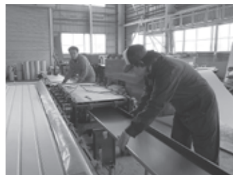
板金屋根材の加工
