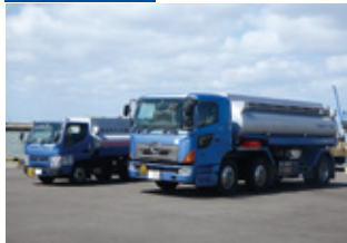
大型タンクローリーと廃油収集バキューム車
