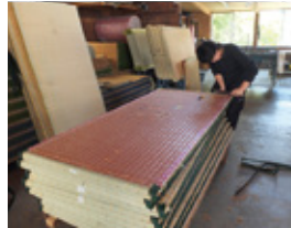
畳表の張り替え作業
