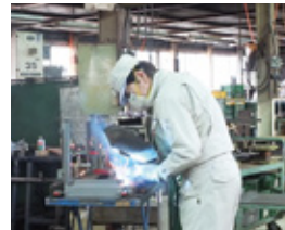
アーク溶接作業
