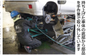
排ガスが出ない電動式自動車解体機でさらに細かく分別します
