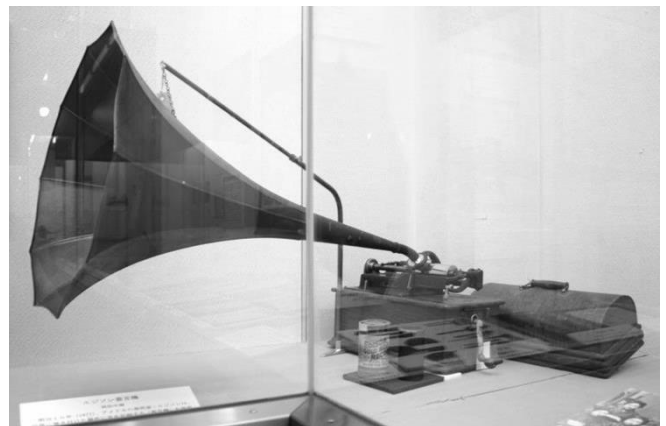
エジソン蓄音機 明治中期 明治10年（1877）、アメリカの発明家・エジソンは、円筒に巻き付けた錫箔に音を記録する「蓄音機」を発明します。この蓄音機は円筒状の「蠟管」を使用する初期型です。 明治30年ごろの巡査の初任給が9円の時代、この蓄音機の値段は約50円と、簡単には買えない高級品でした。明治40年頃から国産化が進み、廉価になります。
