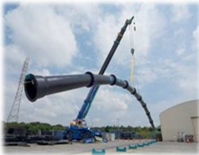
▲耐震管の吊下げ試験
