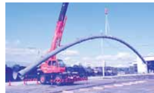
クレーンで吊り下げても抜けない水道管（耐震管） 提供：日本ダクタイル鉄管協会
