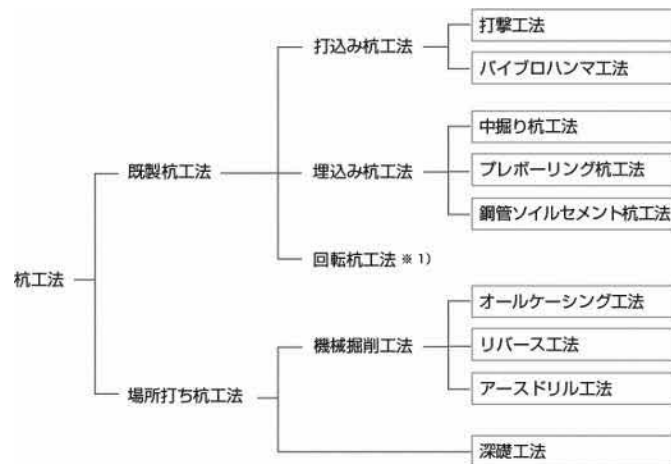
図 5-1-3. 杭基礎の工法的上の分類 [WEB 資料]
