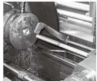
転造盤にて、転造ねじを製造しています。
