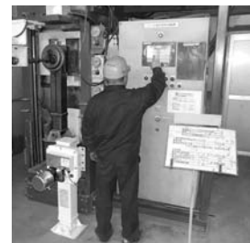
補助脚の荷重試験
