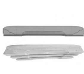
▲3Dモデリングを行い、CNC5軸機で加工した虹梁(部材)
