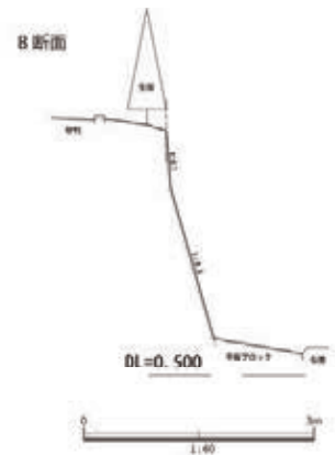
図 5-2-3 川側石垣断面図
