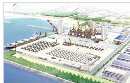
洋上風力発電施設のための基地港湾イメージ (出典：酒田港中長期構想)
