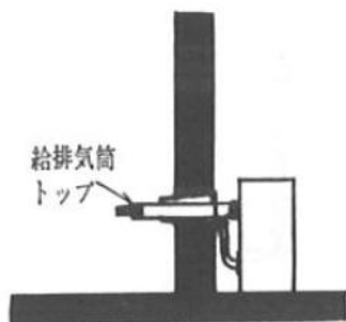
図 外壁式の例
