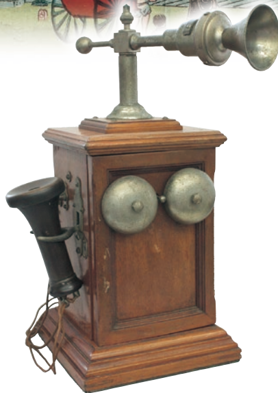
▲デルビル磁石式乙号卓上電話機(明治30年頃)
