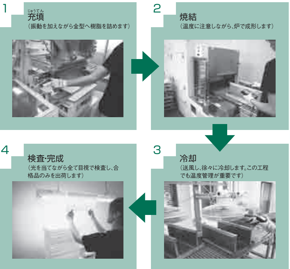
全国各地の排水処理場で使用されている散気材料
