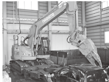
排ガスが出ない電動式自動車解体機で、さらに細かく分別します
