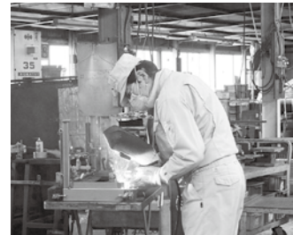
アーク溶接作業
