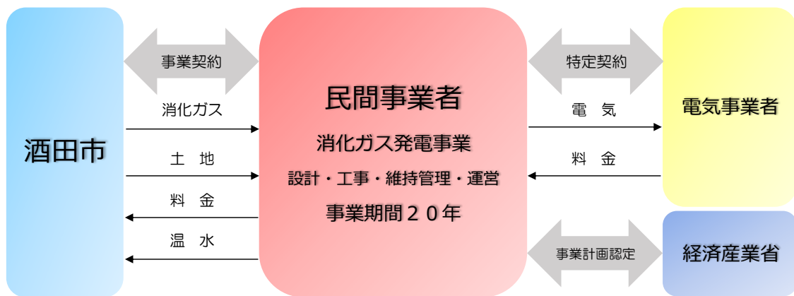
図2-3 消化ガス発電事業のスキーム
