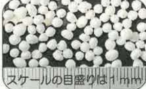
被覆肥料（その他プラスチック） スケールの目盛りは1mm
