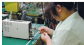
▲ケーブルのストリップ(皮むぎ)作業
