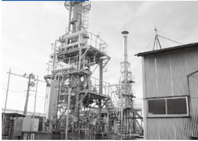
酒田工場(下瀬)左より常圧蒸留塔、加熱炉
