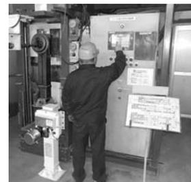
補助脚の荷重試験
