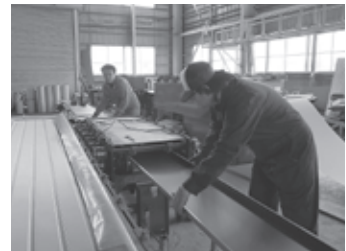
板金屋根材の加工
