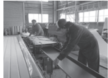
板金屋根材の加工
