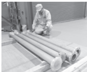
完成した加工管(直管)
