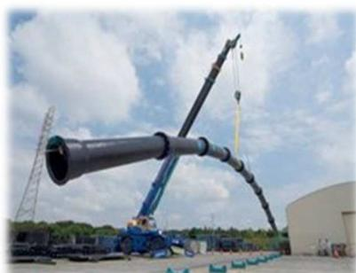
▲耐震管の吊下げ試験
